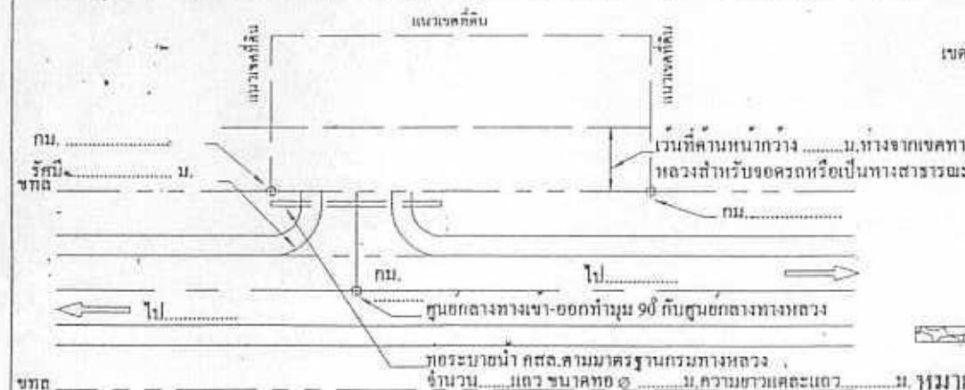
แบบขออนุญาตสร้างท่าง ถนนหรืออื่นสิ่งอื่นใดในเขตท่างหลวงแผ่นดิน และทางหลวงพิเศษ เพื่อเป็นทางเข้า - ออกท้องหลวงแผ่นดิน และทางขานานของทางหลวงพิเศษ สำหรับเข้า-ออก ที่พักอาศัย ที่ดินว่างเปล่าเรือกสวนไร่นา (ไม่มีทางเท้า) แบบแล 37/1(1)
